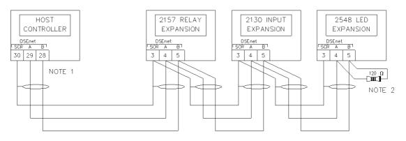
NOTE 1 AS A TERMINATING RESISTOR IS INTERNALLY FITTED TO THE HOST CONTROLLER, THE HOST CONTROLLER MUST BE THE FIRST UNIT ON THE DSEnet
